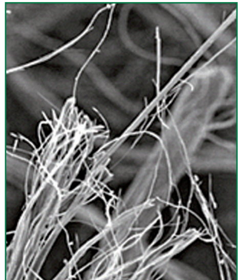
Fibres d'amiante au microscope électronique (x 1 000)
